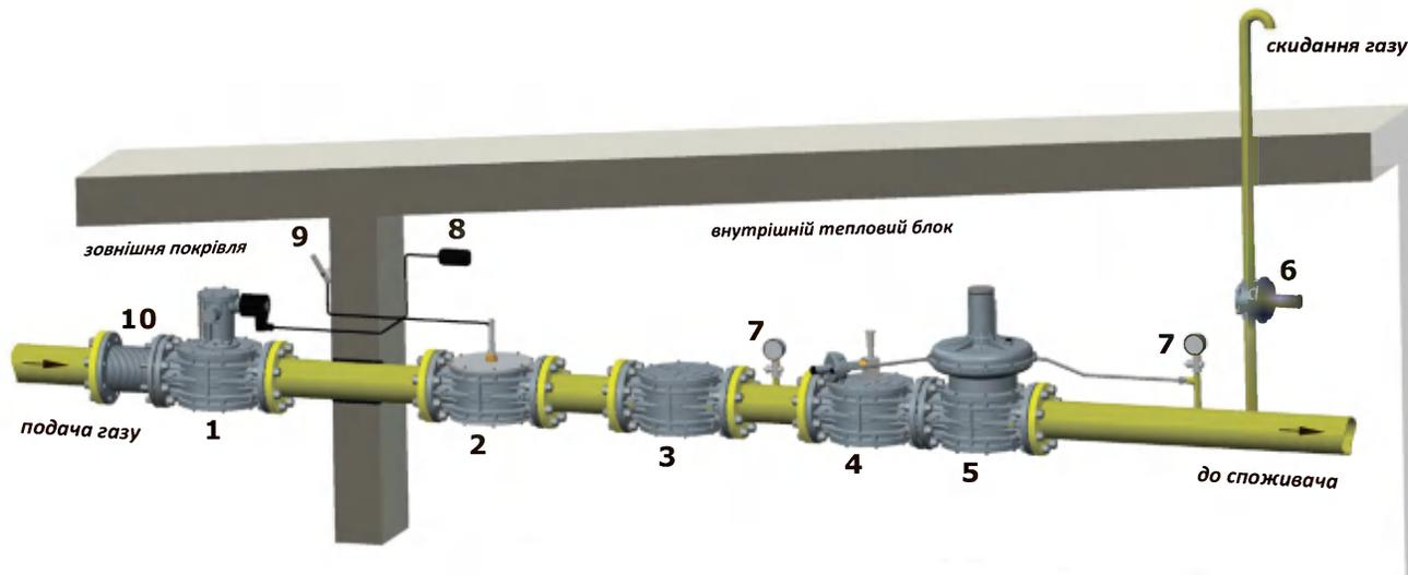
(1) – електромагнітний клапан з ручним зведенням M16/RM N.A.; (2) - Дистанційно керований ручний клапан подачі газу SM; (3) - фільтр газовий FM; (4) - запобіжно-запірний клапан по "max." MVB/1 MAX; (5) - регулятор тиску газу RG/2MC; (6) - запобіжно-сکیدний клапан MVS/1; (7) - манометр; (8) – сигналізатор загазованості; (9) - важіль клапана SM; (10) - компенсаційна вставка
